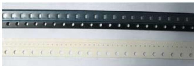
Рис. 12 Пластиковая черная лента шириной 8 мм с преформами размером 0603 производства Indium. Для сравнения, снизу - бумажная лента 8 мм с чипами 01005
